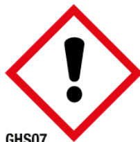
GHS07 Toxicité aiguë catégorie 4 (corrosion, irritations ou sensibilisation oculaires / lésions oculaires) (DA)
